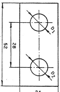
Otvory D1 a D2 přizpůsobit svorku a použitému kabelovému oku
